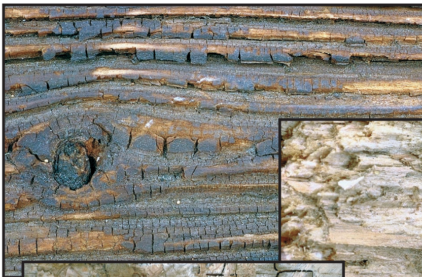
„Rådskade“ med ganske små og her overfladiske sprækkeklodser, men uden overflademycelium.
