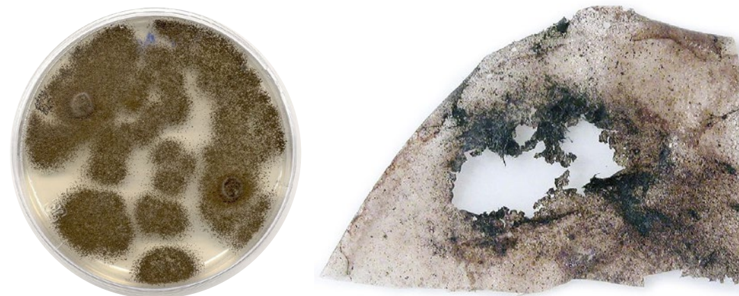
Kultur af Aspergillus tubingensis og polyurethan nedbrudt af Aspergillus tubingensis . Fotos A. Shammah.
